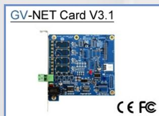
O GV-NET Cartão V3.1 é um conversor RS-485 / RS-232 interface que pode ser instalado dentro de um PC. Ele também suporta conexão via porta USB.
