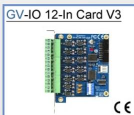
Com 12 entradas digitais, o GV-IO 12-In Card é projetado para trabalhar com o GV-NET/IO para fornecer uma interface para seus dispositivos externos, como sensores e detectores.
