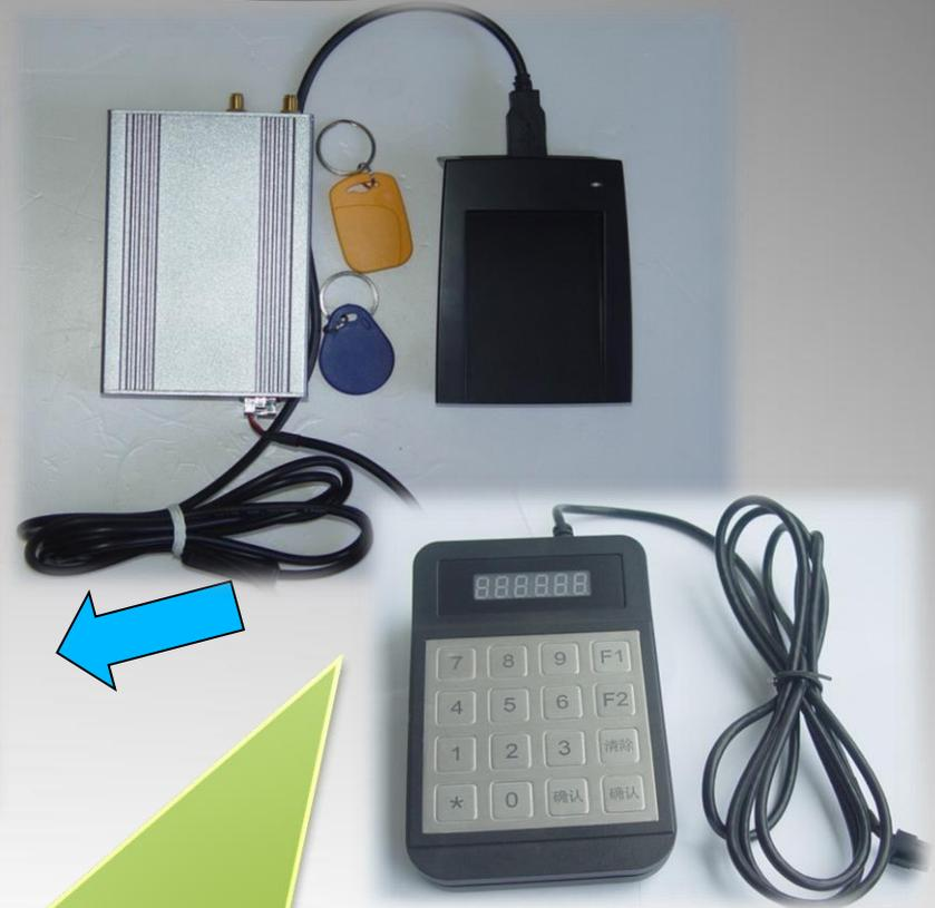
1. Função Imobilizadora: o motorista só poderá ligar o motor através de um Cartão de Identificação ou digitando uma senha, se não tiver o cartão ou a senha, o carro ficará imobilizado.
